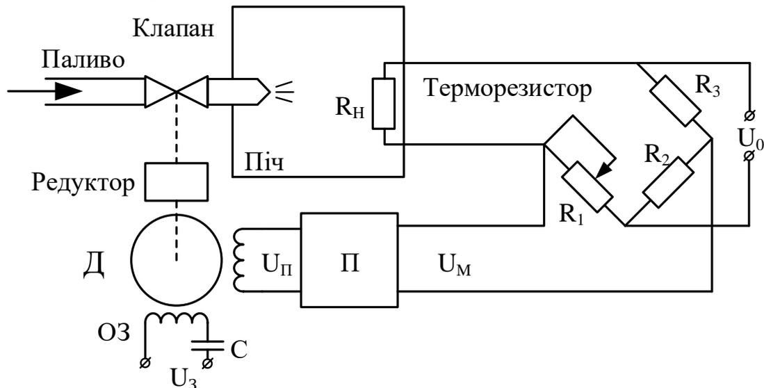
На схемі  $\Theta$  – температура печі (регульована величина);  $\Theta_3$  – задане значення температури печі;  $\Delta\Theta = \Theta_3 - \Theta$  – відхилення температури;  $U_0$  – напруга живлення моста;  $U_M$  – вихідна напруга моста;  $U_y, U_B$  – напруги відповідно керування і збудження двигуна;  $\mu$  – переміщення клапана;  $f$  – збурення.
